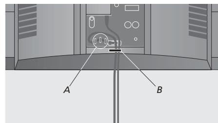
**Закрепление кабелей:** Вы обязаны прикрепить сетевой шнур к BeoVision MX 8000 с помощью трех кабельных скобок (A), расположенных под разъемом для подключения сетевого шнура, и затем закрепить все кабели, подсоединеные к BeoVision MX 8000, кабельным зажимом (B).
