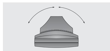
Если Ваш BeoVision MX 8000 оснащен подставкой с электроприводом, то при выборе места установки убедитесь в наличии достаточного пространства для поворота BeoVision MX 8000 в обе стороны, как показано на рисунке.
