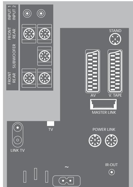
Разъем для ввода сигнала наружной антенны ТВ (или кабельного ТВ). Если Ваш BeoVision MX 8000 оснащен встроенным модулятором системы, подключите Вашу наружную antennу ТВ к разъему TV, расположенному под разъемом, помеченным LINK.
